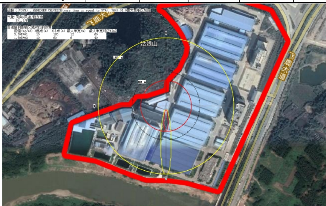
图 4.2-30 盐酸储罐泄漏事故最不利气象 HCl 浓度扩散最大影响范围图
