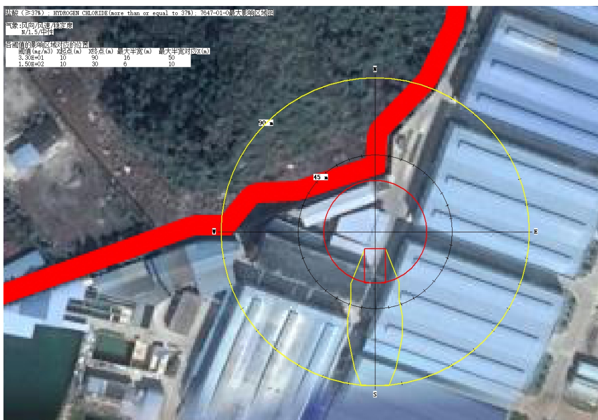
图 4.2-32 盐酸储罐泄漏事故最常见气象 HCl 浓度扩散最大影响范围图
