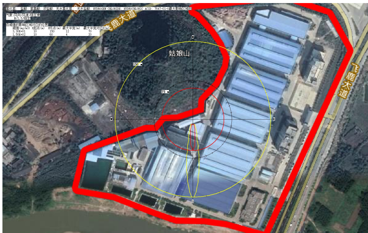
图 4.2-34 四氯化钛储罐泄漏最不利气象 HCl 浓度扩散最大影响范围图
