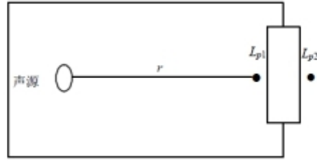
图 4.2-24 室内声源等效为室外声源图例
