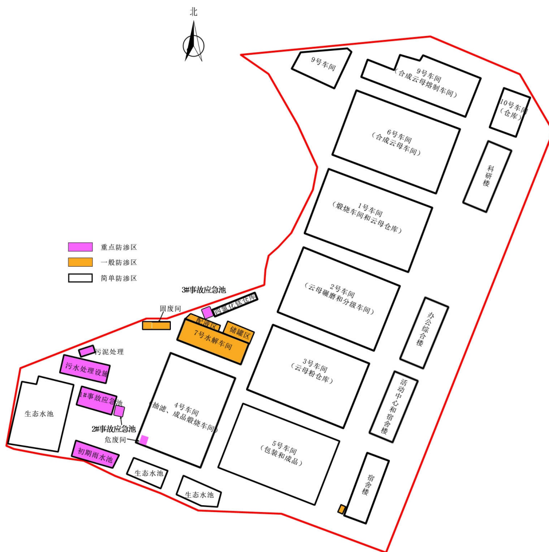
图 5.2-5 地下水污染分区防渗示意图
