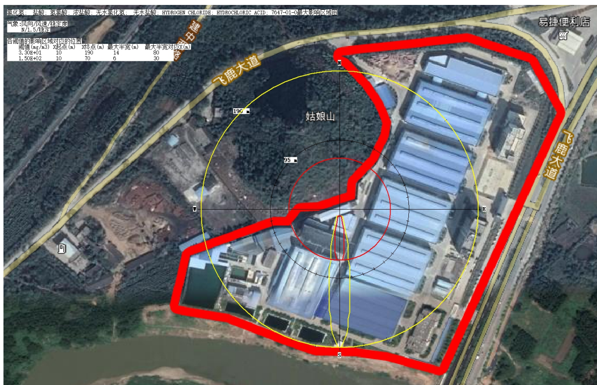
图 4.2-36 四氯化钛储罐泄漏最常见气象 HCl 浓度扩散最大影响范围图
