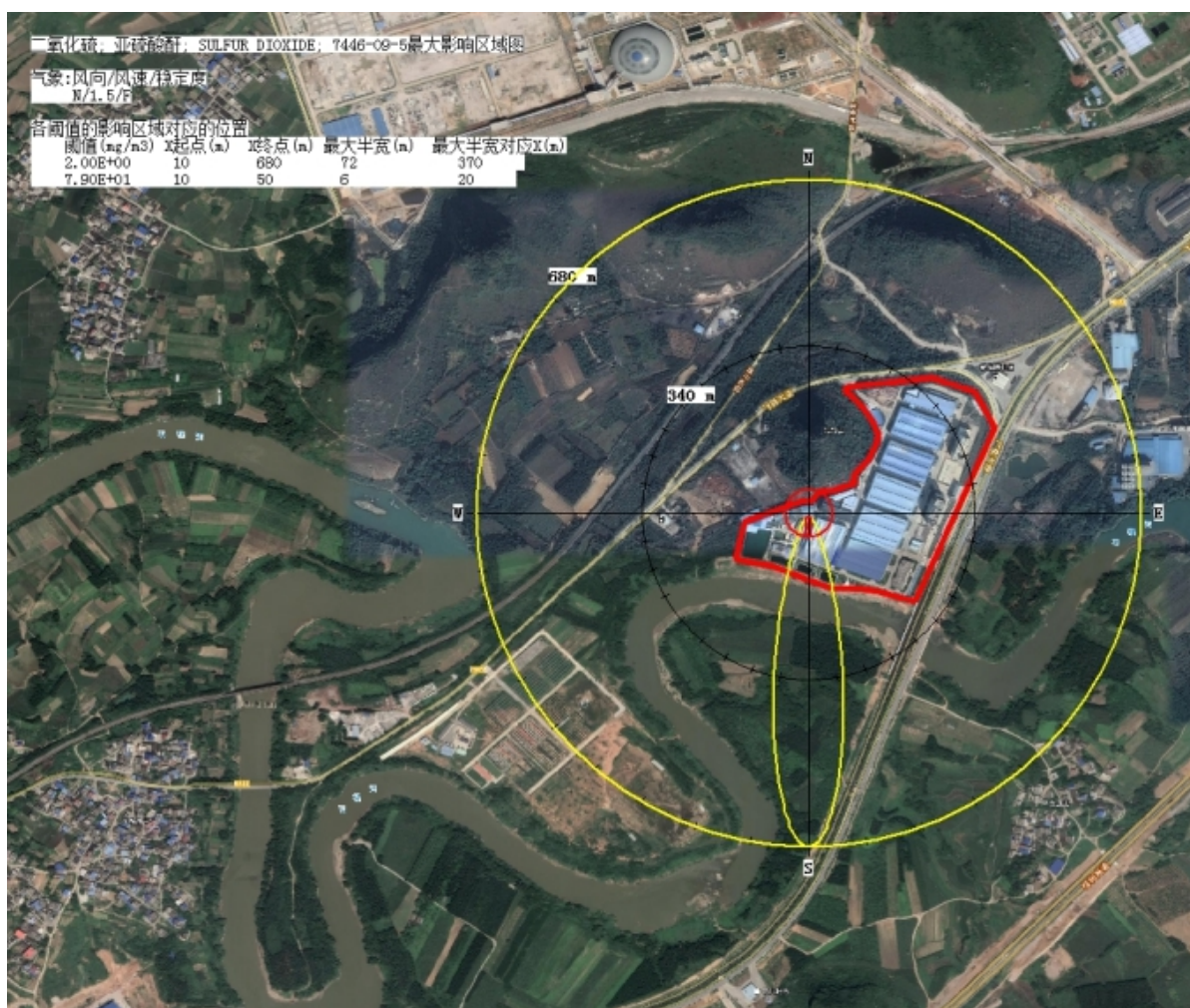
图 4.2--40 生物质燃料火灾事故情景最不条件 \text{SO}_2 不同毒性终点浓度的最大影响范围图
